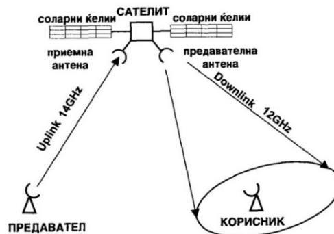
Сл. 6-20. Принцип на сателитскиот радиодифузен пренос
