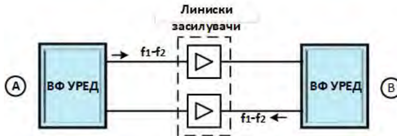
Сл. 3-4. Блок-шема на четирижичена ВФ-врска со иста фреквенција на каналите во двете насоки
